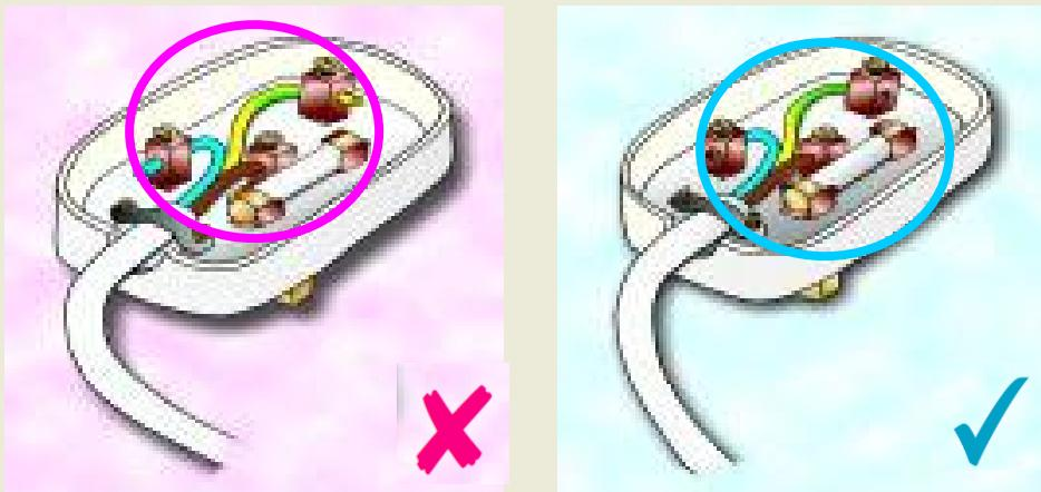
Atunci când se montează un ștecher pe un cablu, în primul rând se îndepartează izolația exterioară și izolațiile clablurilor interioare pe o lungime potrivită.
