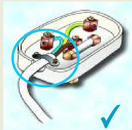
Fixati ferm cablul la stecher folosind placuta de prindere a stecherului. Fixati placuta de prindere pe izolatia esteroara a cablului, nu pe firele interioare
